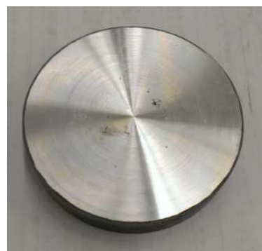
شکل (۳): تصویری از نمونه‌ها بعد از تراش‌کاری جهت صاف کردن سطح نمونه
