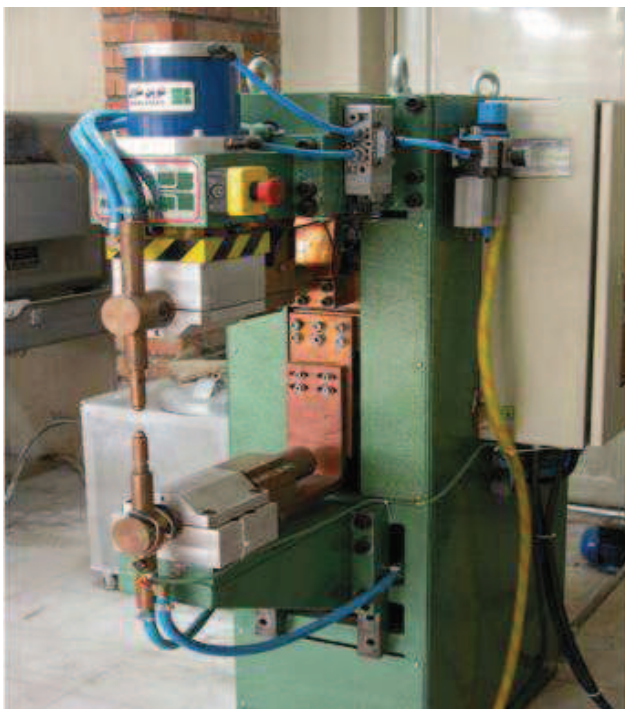
شکل (۱): دستگاه جوشکاری مقاومتی نقطه‌ای مورد استفاده در این تحقیق
