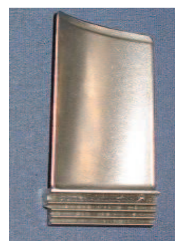
شکل (۳): پره ماشینکاری شده ردیف دوم توربین گازی رستون TA1750
