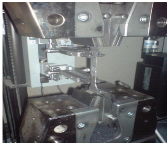
شکل (۸): دستگاه ZWICK در حالت تست نمونه‌ها
