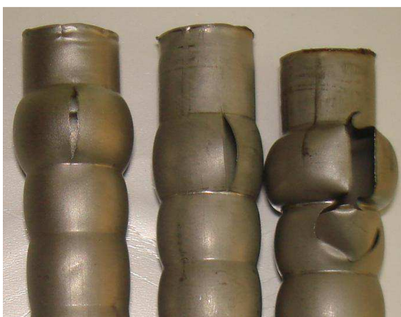
شکل (۴): نمونه بیلوزهای پاره شده در فشار 135 bar
