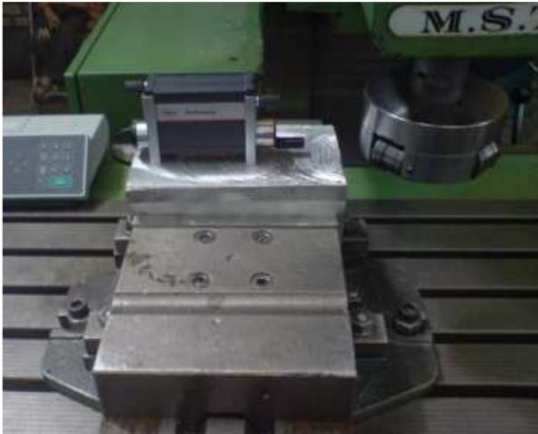
شکل (۸): دستگاه زبری سنج جهت اندازه‌گیری صافی سطح
