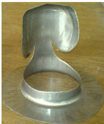
شکل (۷): پارگی در قطر 102\text{ mm}
