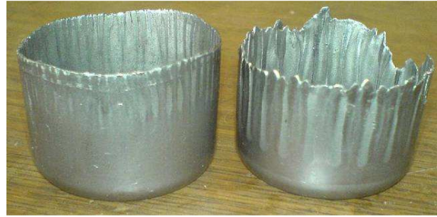
شکل (۱۰): مقایسه قطعه تولیدی با گپ ایجاد شده توسط ارینگ و قطعه تولیدی با گپ ۰/۵۵ mm
