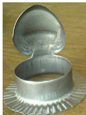
شکل (۶): پارگی در قطر 101\text{ mm}
