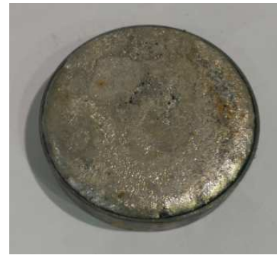
شکل (۲): تصویری از نمونه‌ها بعد از پوشش‌دهی توسط بابت
