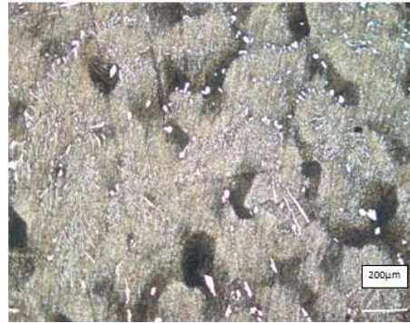
شکل (۶): آلیاژ پایه قلع حاوی ۱.۴ درصد مس ، ۷.۸ درصد آنتیمون و ۹۰.۸ درصد قلع
