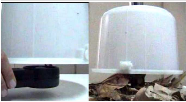
شکل ۴. نمایی از آزمایش و دستگاه بادسنج قرار داده شده در زیر لوله مکش برای ثبت میزان دبی عبوری هوا
